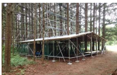
人工林の大規模な降雨遮断実験
